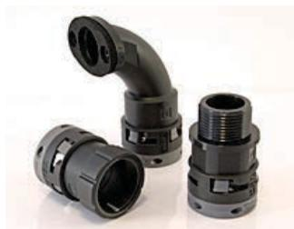
Le corps des raccords Grip Lock se présente en diverses configurations. Ces composants sont offerts en nylon et en métal dans tous les types et tous les formats de filets. Leurs collets de verrouillage intégrés révolutionnaires en facilitent la pose et les maintiennent en place fermement pour prévenir la perte des composantes de verrouillage.
